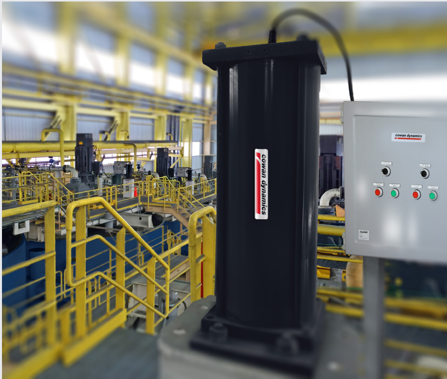
Modèle AT, alésage 14", avec panneau de commande pneumatique actionnant une vanne à tête de flèche dans une application minière avec cellule de flottation.
